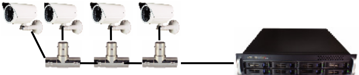
DVRからの1本のケーブルのカメラを接続 (ループ接続) 最大16台接続可能
