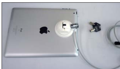
■セキュリティスロット部にシリンダ錠を取り付ける
